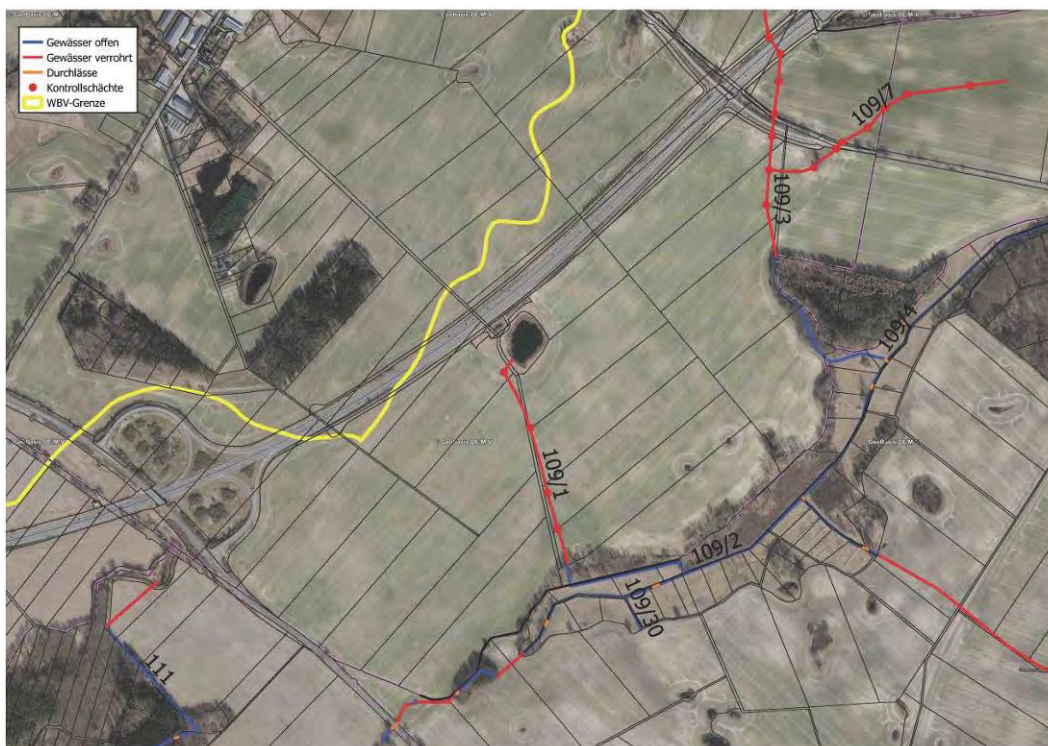
Abb. 22: WBV-Grenze (gelb) und im Plangebiet liegender Vorfluter 109/1 (WBV 2023)
